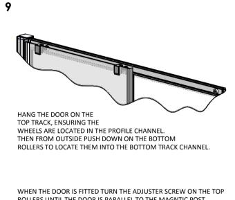
ROLLERS UNTIL THE DOOR IS PARALLEL TO THE MAGNTIC POST.
